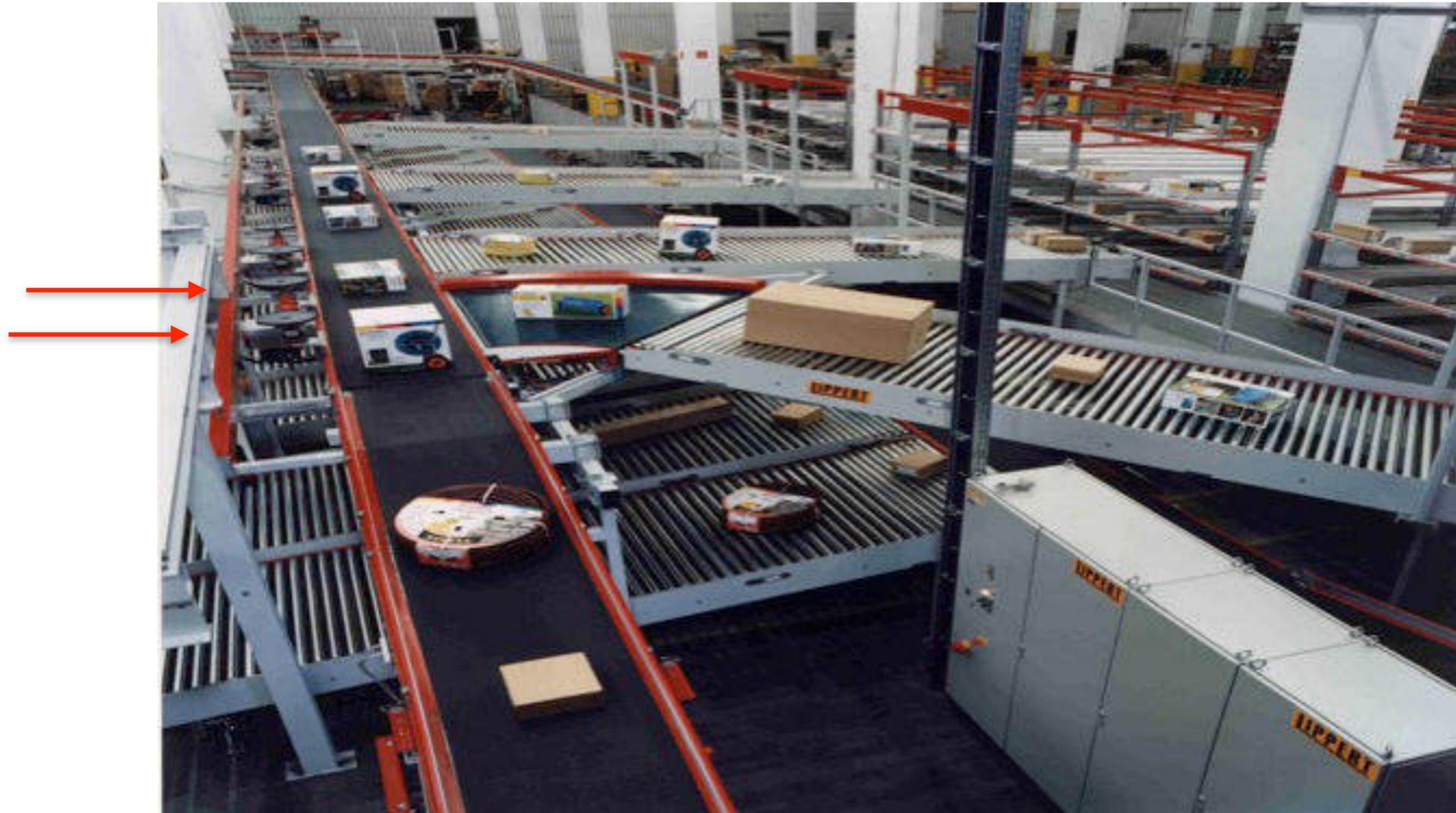
Sortieranlage - Ausschleusung durch Pusher
