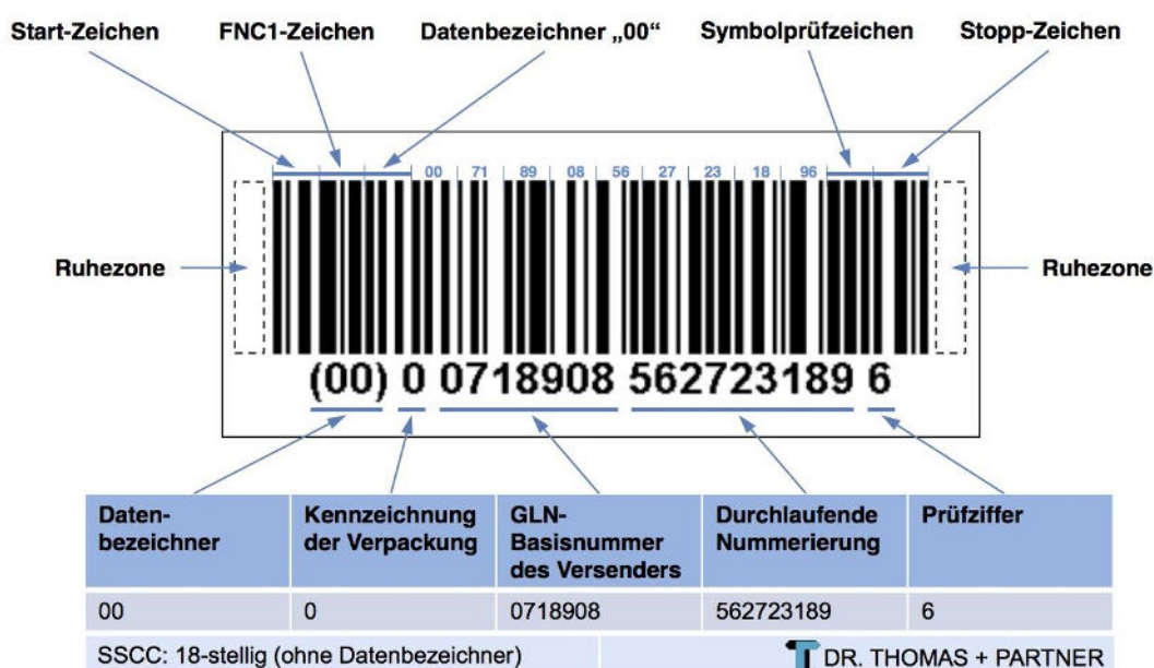
Beispiel eines Code nach GS1-128: SSCC (Serial Container Shipping Code)
