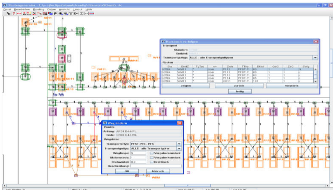
Abbildung 2.3: Anlagenabbild (Teilansicht). Mit Hilfe einer graphischen Oberfläche wird das Anlagenbild im MFCS abgelegt
