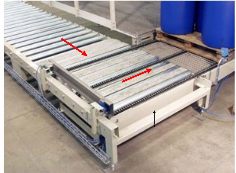
Palettenrollenbahn heb- und senkbar zur Palettenübergabe auf einen rechtwinklig angeordneten Tragkettenförderer (Quelle: www.feige.com )
