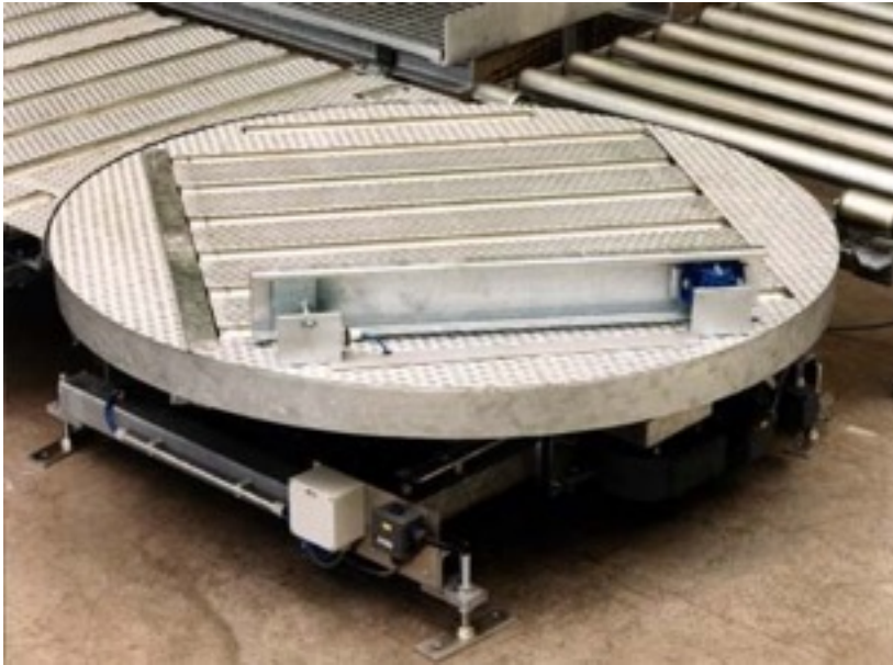
Drehtisch mit Palettenrollenbahn zur Palettenumsetzung auf eine rechtwinklig angeordnete Palettenrollenbahn. (Quelle: www.feige.com )
